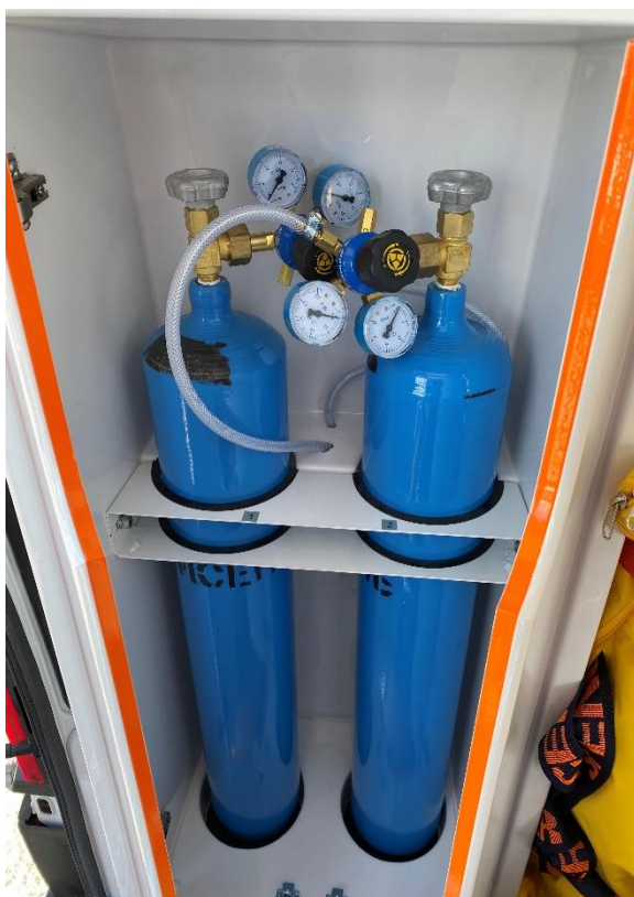
Стационарний кисень в автомобілі ЕМД на базі Ford Transit (тип С)
