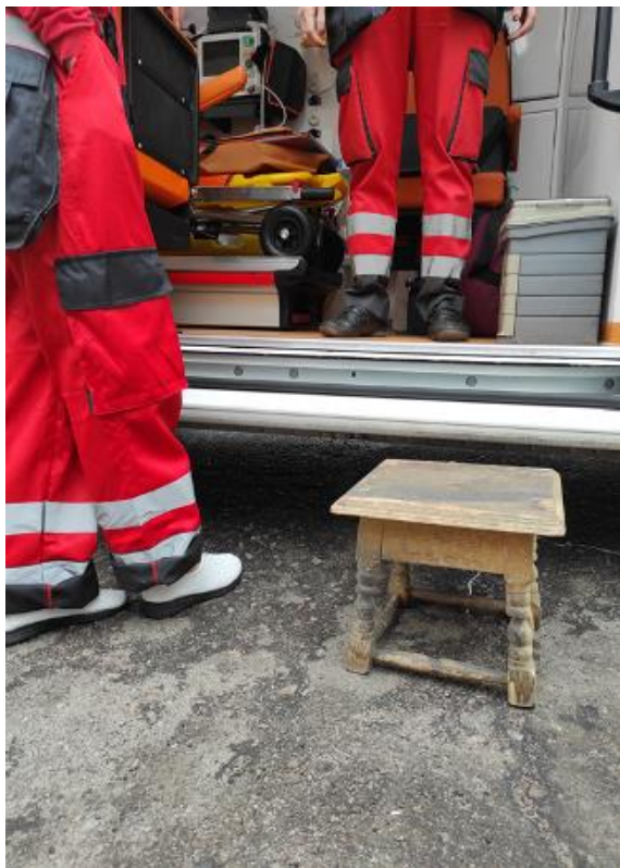
Через високий поріг медичного салону (53 см) бригади ЕМД вимушені возити із собою стільці задля полегшення потрапляння до салону автомобіля хворих літніх людей та медперсоналу
