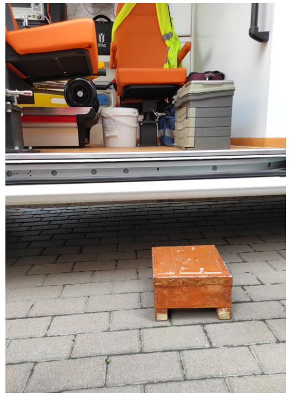
Через високий поріг медичного салону (53 см) бригади ЕМД вимушені возити із собою стільці задля полегшення потрапляння до салону автомобіля хворих літніх людей та медперсоналу
