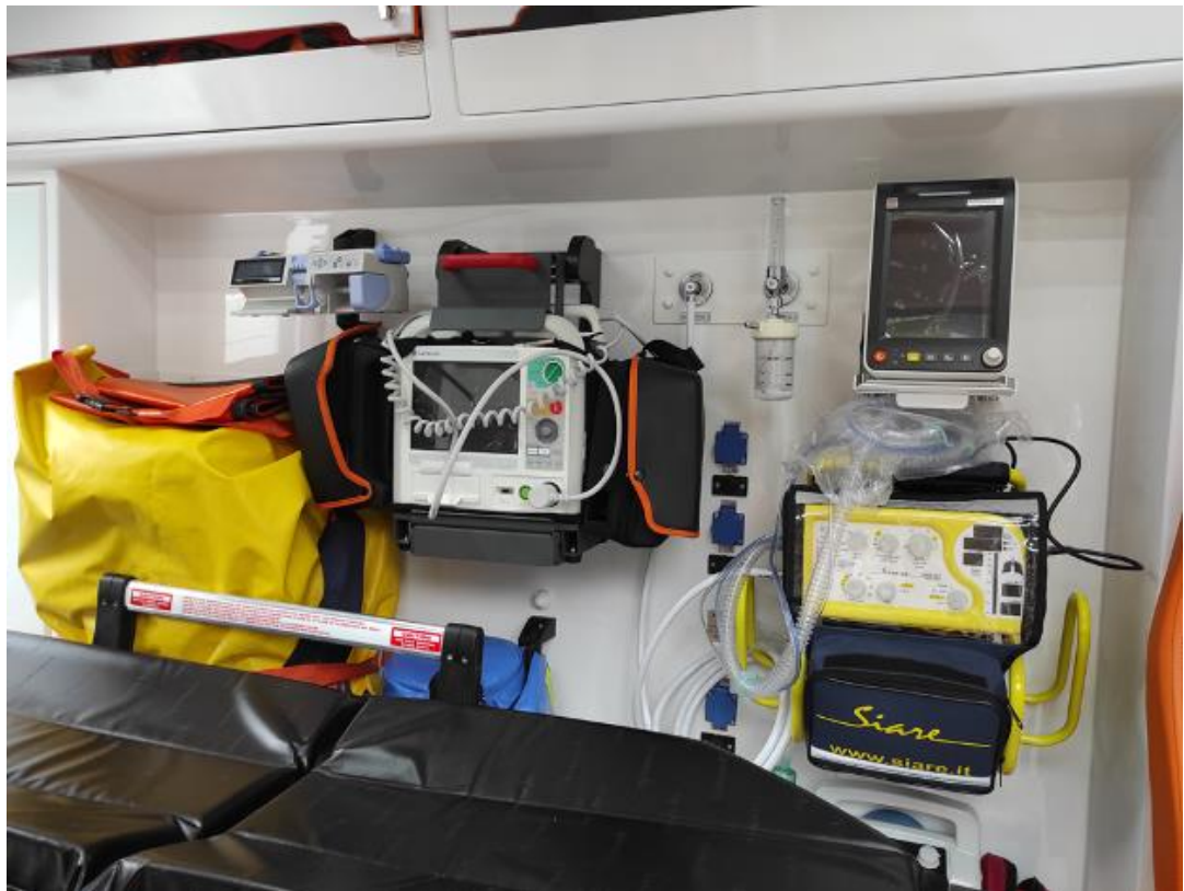
Салон автомобіля ЕМД на базі Peugeot Boxer (тип С) з дефібрилятором і апаратом ШВЛ SIRIO S2/T (жовтий) без редуктора
