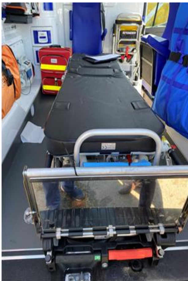
Ноші-каталка, встановлені у автомобілі ЕМД на базі Ford Transit (тип В)
