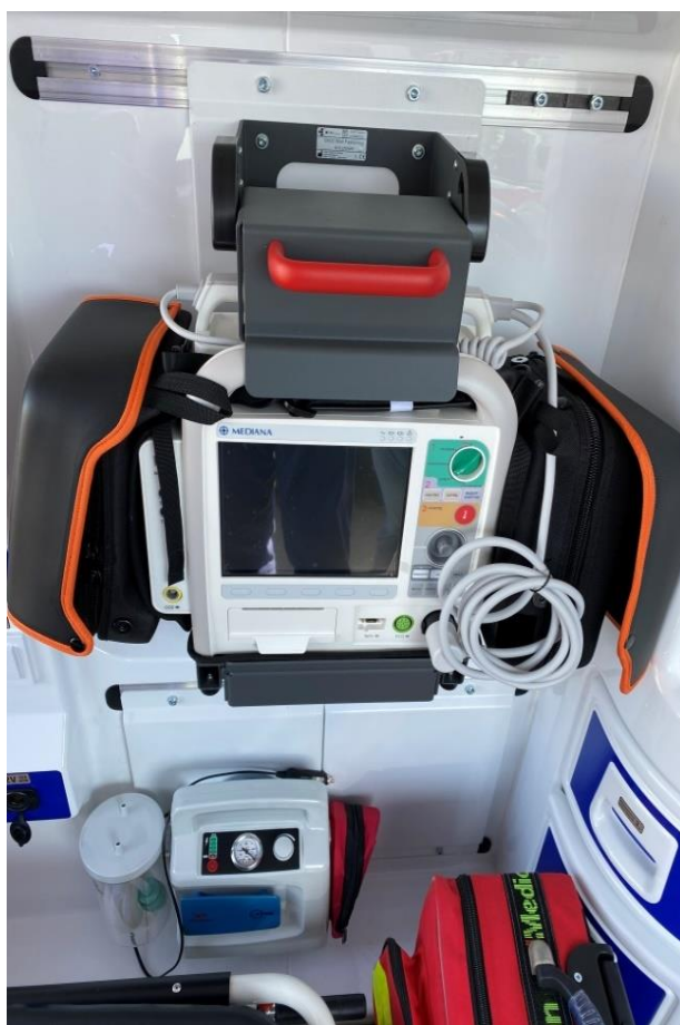
Дефібрилятор, встановлений у автомобілі ЕМД на базі Ford Transit (тип В)
